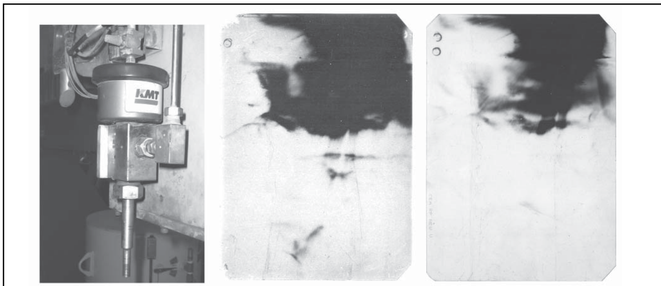
Рис. 9. Изображение на последовательно сложенных без зазора рентгеновских пленках, свернутых в форме цилиндра, расположенные коаксиально с цилиндрическим штоком на расстоянии 7 мм и установленные так, чтобы по вертикали перекрывать конец штока (верхняя темная часть пленки) и область выхода воды из канала. Левая пленка находилась ближе к штоку, а правая – вплотную за ней. Положение пленок показано на левом рисунке.
