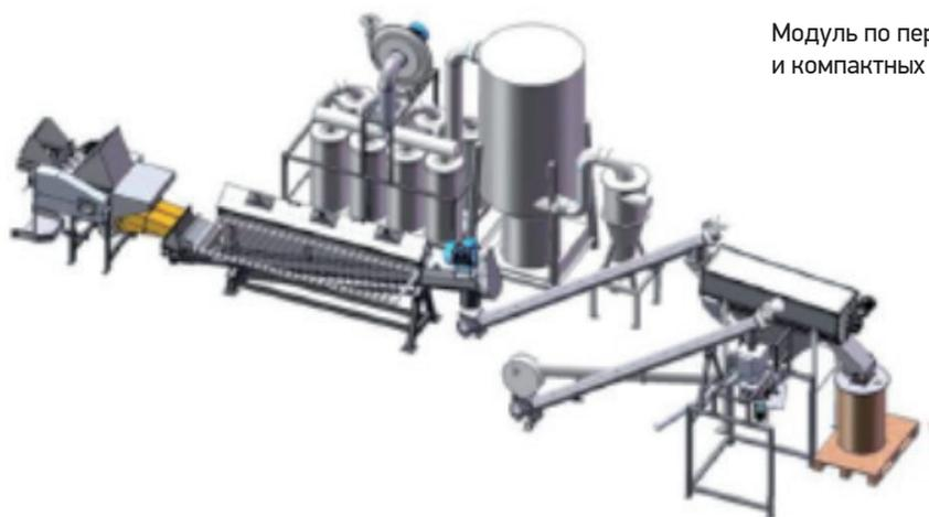
Модуль по переработки трубчатых и компактных ламп LP 200
