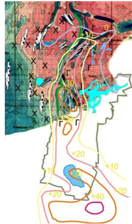
Ил. 6. Схема геологического строения Кенозерского национального парка. Карбон. C2 kc – известняки, мергели, глины, алевролиты, конгломераты мощностью 150 м; C2 ms – песчано-глинистая, глинисто-карбонатная толщи дельтового и прибрежного происхождения, органогенные известняки; C2 rd – известняки, доломиты, реже мергели общей мощностью до 50 м; C2 kc' – красноцветные слюдистые песчаники, алевролиты, известковистые глины с прослоями конгломератов и известняков общей мощностью 60–70 м; C1 s – мелководные доломитизированные известняки, доломитами с отдельными прослоями глины мощностью 40–60 м; C1 al-vn – переслаивание песчано-глинистых разностей с известняками мощностью 5–65 м. Девон. D3 st – переслаивание глины и алевролитов в верхней части разреза и тонко- и мелкозернистыми песками и песчаниками – в нижней мощностью ~ 50 м; D3 sr – толща чередующихся песков, песчаников, глины и алевролитов мощностью 40–95 м. Pr1 – Винельская дайка ультрамафитов, Ar2 vog – габбро (серое) и ультрамафиты, Ar2 vog2 – гранитоиды неогархея, Ar2 vog1 – осадочно-вулканогенные породы вожминской свиты мезогархея, Ar1-2 – ТТГ, Ar1 vol – волоцкая свита палеогархея. 1 – внешний контур аномалии ртути в почвах КНП, 2 – солевые аномалии Ni-Cu-Co, 3 – внутренние контуры ртутных аномалий, 4 – условная граница палео- и мезо-неогархея
