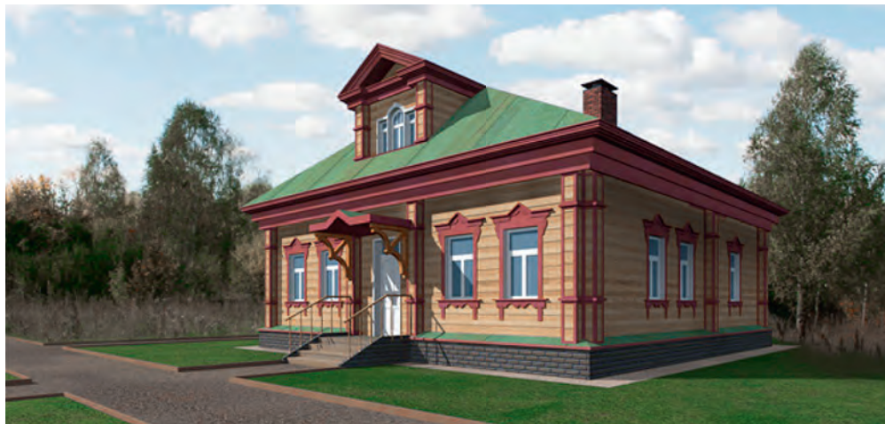
Ил. 3. Одноэтажный деревянный на каменном фундаменте жилой дом «Тип 3»
